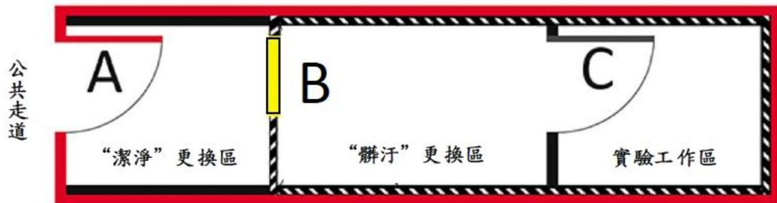
鑑別出來。圖 1-6 顯示前室提供由走道進入走進 BSL-3 工作區需經一系列三道門。圖中說明門的組合設計，必須防止門的同時開啟，以維持阻隔屏障。
